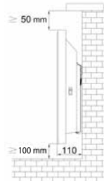
Şekil 9. Konvektörün montaj olmuş ölçüleri
