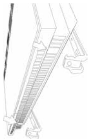
Bild 6. Aufsetzen der Heizung auf unteren Haken
