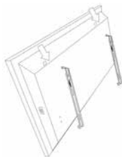
Figura 8. Vedere spate fixare parte superioară
