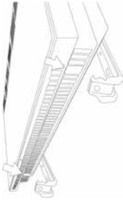
Şekil 6. Alt kancaya konvektörün oturtulması
