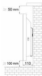
Obrázek 9. Montážní rozměry konvektoru
