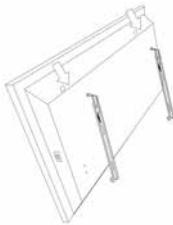
Şekil 8. Üst kancanın takılması arkadan görünüşü
