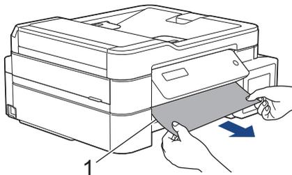
5. Тщательно осмотрите устройство внутри (1) на предмет обрывков бумаги.
