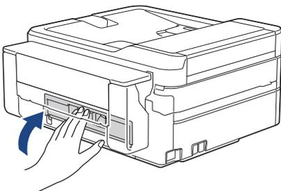
8. Задвиньте лоток в устройство до упора.
