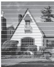
После прочистки этого сопла горизонтальные линии исчезают:
