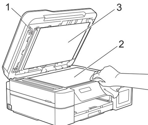
3. В узле АПД очистите белую планку (1) и стеклянную планку (2) безворсовой тканью, смоченной в воде. (только для моделей с АПД)
