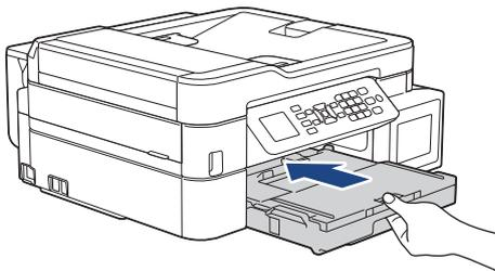
8. Придерживая лоток для бумаги в устройстве, выдвиньте опорную панель (1) до защелкивания на месте, а затем раскройте щиток опорной панели (2).
