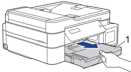
3. Очистите разделительную площадку (1) мягкой безворсовой тканью, смоченной водой. Закончив очистку, протрите площадку сухой, мягкой неворсистой тканью, чтобы полностью удалить влагу.
