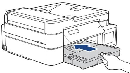
14. Придерживая лоток для бумаги в устройстве, выдвиньте опорную панель (1) до защелкивания на месте, а затем раскройте щиток опорной панели (2).
