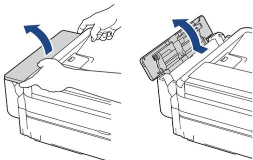
2. Поднимите опорную панель.
