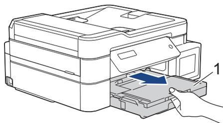
4. Очистите переднюю поверхность роликов подачи бумаги (1) мягкой безворсовой тканью, смоченной водой (протирайте по направлению вдоль роликов). Закончив очистку, протрите ролики сухой, мягкой безворсовой тканью, чтобы полностью удалить влагу.
