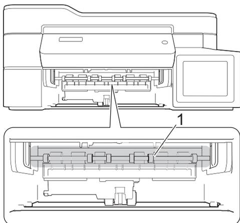
6. Возьмитесь обеими руками снизу за пластиковые фиксаторы с обеих сторон устройства, поднимите и откройте крышку сканера (1).
