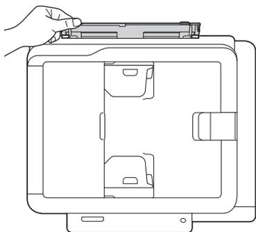
2. Поднимите опорную панель.
