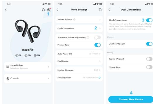
Для подключения наушников к двум устройствам Bluetooth одновременно откройте приложение soundcore, перейдите в настройки и выберите Двойное подключение > Включить двойное подключение > Подключить новое устройство.
