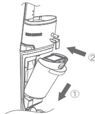
4 Umieść dolną część zbiornika na brudną wodę w odpowiednim miejscu na korpusie produktu i delikatnie dociśnij go do korpusu produktu. Gdy usłyszysz kliknięcie, oznacza to, że zbiornik na brudną wodę został zainstalowany prawidłowo.
