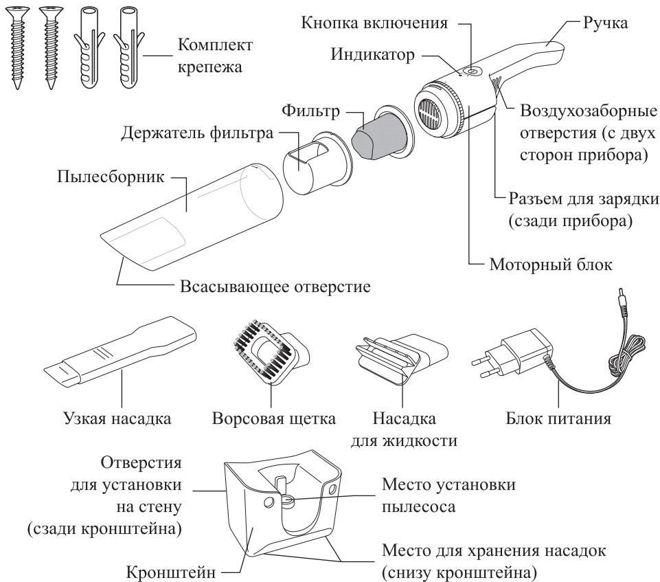
Включить и выключить прибор, а также изменить скорость работы можно с помощью **кнопки включения**, расположенной на моторном блоке. Нажмите на кнопку включения,
