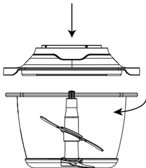
3. Установите моторный блок на крышку и закрепите, слегка повернув его.
