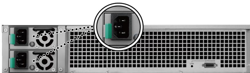
**Примечание.** Устройство RX1217RP поставляется с запасной системой электропитания, которая позволяет подключение двух кабелей питания. Систему можно включить только с помощью одного кабеля питания, но во избежание сбоев питания рекомендуется использовать два кабеля.
