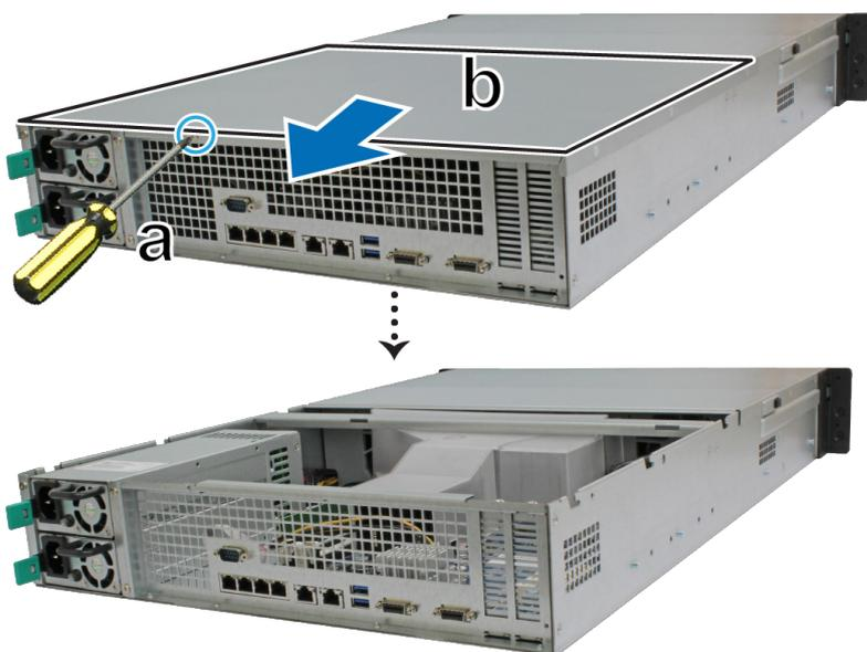
**Примечание.** После снятия верхней крышки задней части устройства чувствительные внутренние компоненты остаются без защиты от внешних воздействий. Не трогайте внутренние компоненты, кроме блока памяти при его извлечении или установке.
