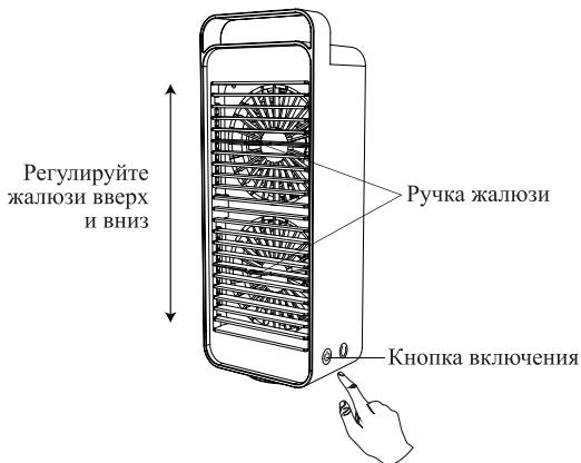
У вентилятора три скорости работы. Скорости работы устанавливаются циклическим нажатием на кнопку включения. В зависимости от скорости время работы будет разное. Чем ниже скорость, тем дольше проработает вентилятор.
