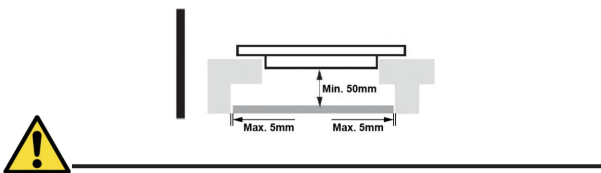
Снаружи варочной поверхности есть вентиляционные отверстия. НЕОБХОДИМО убедиться, что эти отверстия не заблокированы столешницей, когда при установке варочной поверхности.
