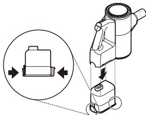
**2** Чтобы вынуть аккумулятор из зарядной станции, нажмите на кнопку, находящуюся в задней части аккумулятора и приподнимите его.
