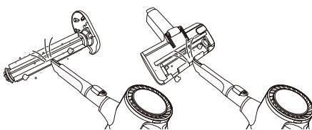
4 Вставьте торец щетки ② в паз ③ на боковой внутренней стороне насадки (торец щетки/паз).
