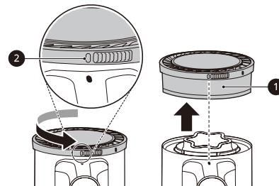
**2** Приподнимите фильтр предварительной очистки ③ и выньте его из корпуса прибора.
