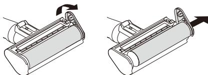
**4** Установите щелевую насадку на корпус и с помощью вакуума удалите посторонние предметы и пыль из щетки и с нижней части насадки.
