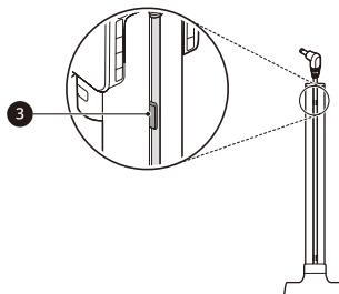
**4** Вставьте съемный модуль для хранения насадок **④** или съемный модуль для хранения моющей насадки и моющих щеток **⑤** в опорную трубу зарядной станции.
