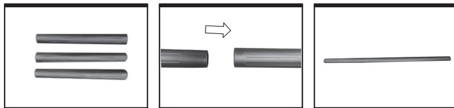
4. Подсоедините одну из комплектных насадок к трубкам, затем полученную конструкцию подсоедините к всасывающему шлангу.
