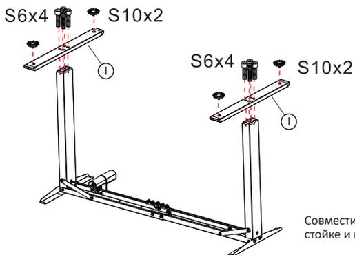
Совместите разъемы на опорной стойке и на ножке. Вставьте и затяните винты.
