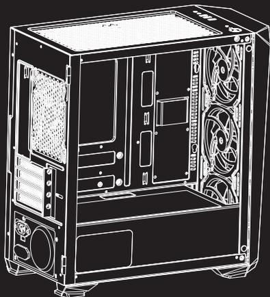
Разместите вентиляторы на одной из панелей (верхняя, передняя, задняя) и зафиксируйте их.
