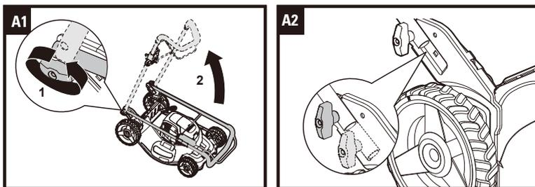
1. Ослабьте фиксатор нижней рукоятки, повернув его против часовой стрелки и вытяните нижнюю рукоятку.
