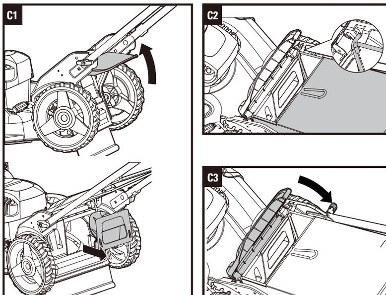
1. Поднимите крышку заднего желоба для выброса травы и удерживайте ее в таком положении. Снимите насадку для мульчирования, если она была установлена (см. рис. C1).
