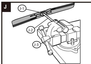
Проверьте баланс ножа, надвинув нож через центральное отверстие J-1 на гвоздь или отвертку J-2, зажатые горизонтально в тисках J-3. Если один из концов ножа наклонится вниз, обработайте этот конец напильником. Нож правильно сбалансирован, если ни один из его концов не клонится вниз.
