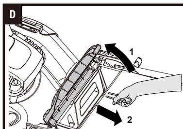
Регулярно опорожняйте травосборник во время работы. Не ждите его полного заполнения. Рекомендуется опорожнять его при заполнении наполовину.
