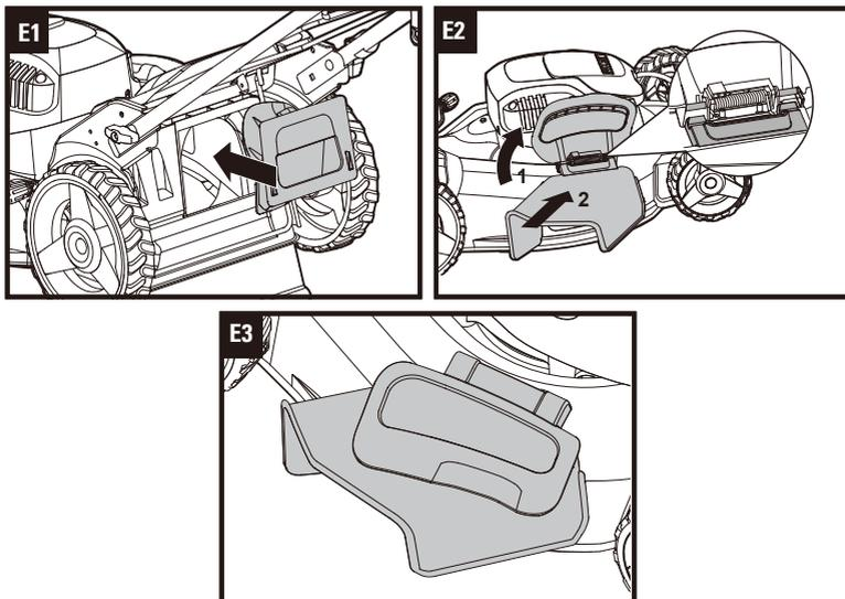
**ПРИМЕЧАНИЕ:** боковой желоб для выброса травы используется для выброса скошенной травы с боковой стороны устройства во время ее работы. Для использования этой функции травосборник должен быть снят.
