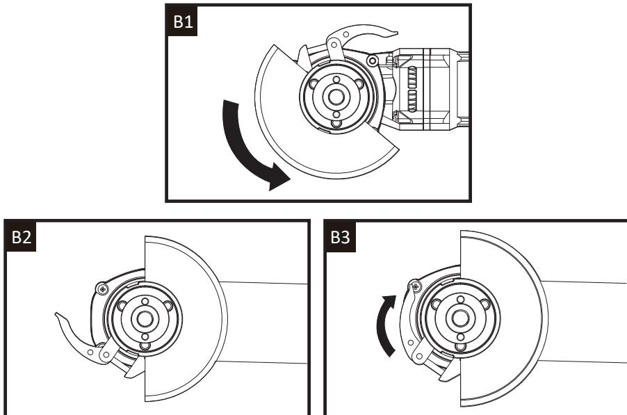
**ПРИМЕЧАНИЕ.** При открытом зажимном рычаге можно отрегулировать регулировочный зажимной винт для обеспечения надежной фиксации кожуха после окончательного закрытия зажимного рычага.
