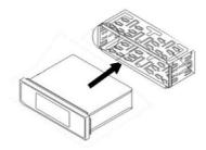
2. Установите монтажную скобу в разъём для магнитолы в приборной панели автомобиля. Предварительно проверьте, подходит ли скоба по размеру к разъёму в панели. Если она не проходит в разъём, Вам необходимо обратиться в специализированный центр автозвука или автосервис для расширения отверстия на приборной панели.
