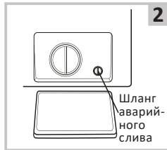
2 Поверните заглушку шланга аварийного слива воды на 90° и вытяните шланг. Снимите заглушку.
