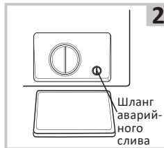
2 Поверните заглушку шланга аварийного слива на 90° и вытяните шланг. Снимите заглушку
