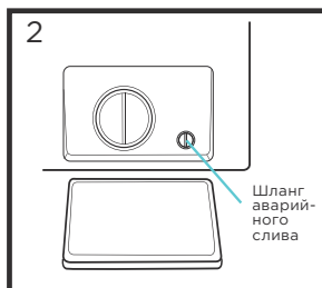
Поверните заглушку шланга аварийного слива воды на 90° и вытяните шланг. Снимите заглушку.
