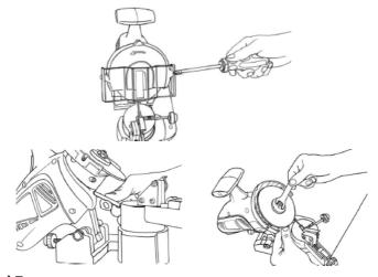
Внимание! Положение суппорта цепи можно менять только когда устройство отключено и находится в неподвижном состоянии. Избегайте длительной заточки одного зубца, чтобы избежать повреждения цепи и чрезмерного слоя стачивания. Максимальное количество материала, которое можно убрать с одного зуба, отличается между разными цепями, уточните эту информацию у производителя цепи.
