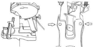
С помощью крепежного болта и ключей из комплекта, закрепите станок на основании.
