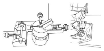
Закрепите основание на верстаке, используя монтажные отверстия при помощи болтов (в комплект поставки не входят).
