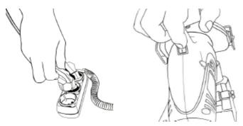
Включите станок, нажав на выключатель на рукоятке. После чего ослабьте и продвиньте цепь (в направлении заточного круга) пока следующий зуб с таким же направлением заточки не пройдет установочный клин. Направление заточки зубьев в цепи одинаково через один зуб. Потяните цепь в обратную сторону чтобы зуб уперся в клин, зафиксируйте цепь и, включив станок, произведите заточку.
