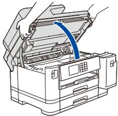
Поднимите крышку сканера.
