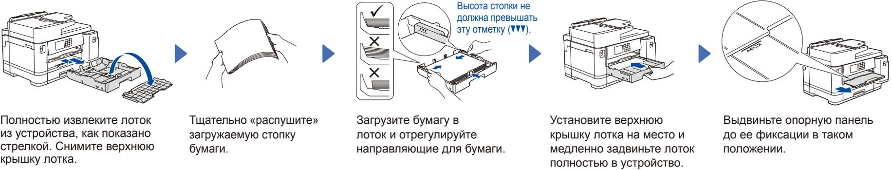
Полностью извлеките лоток из устройства, как показано стрелкой. Снимите верхнюю крышку лотка.
