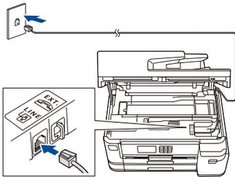
Подключите телефонный провод. Для подключения используйте гнездо с маркировкой **LINE** и выведите провод наружу через заднюю стенку устройства.
