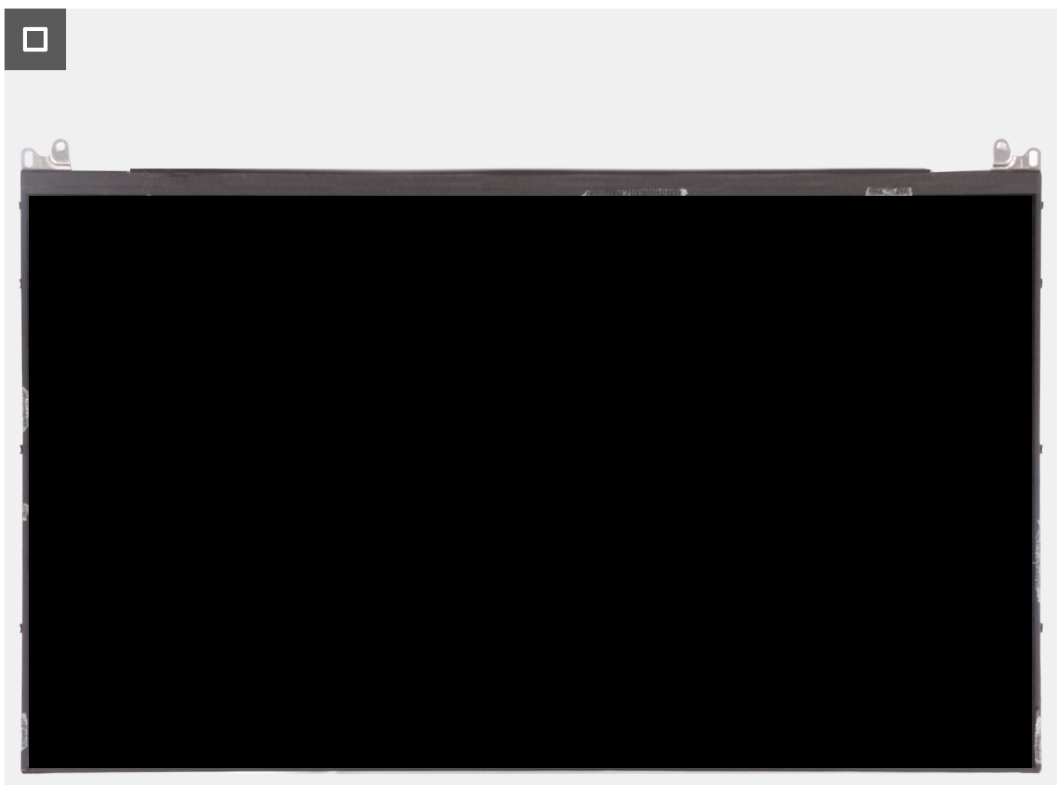
Рисунок 76. Снятие панели дисплея (ноутбук)
