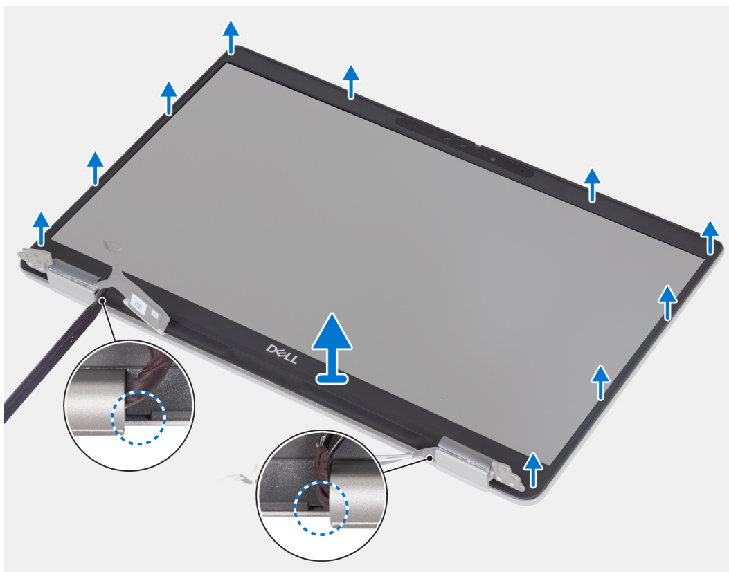
Рисунок 67. Снятие рамки дисплея (ноутбук)
