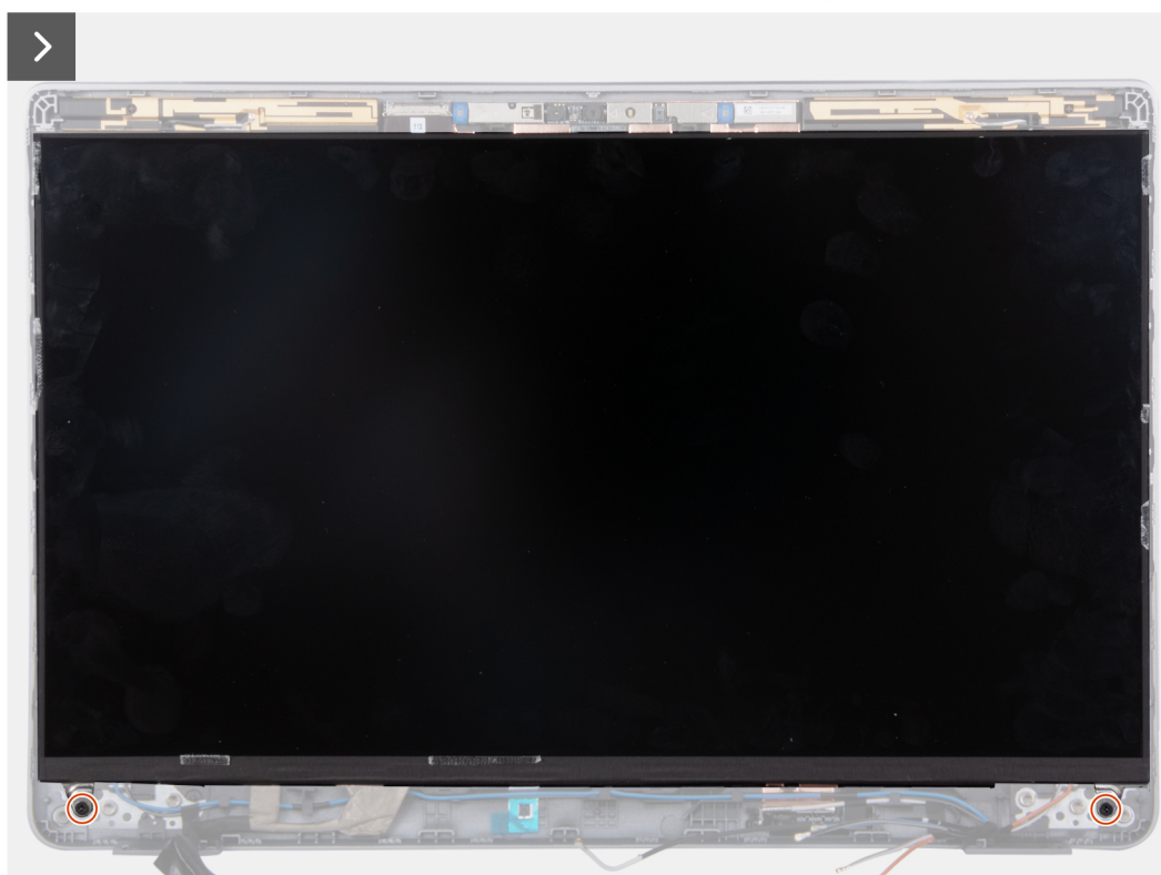
Рисунок 72. Снятие панели дисплея (ноутбук)
