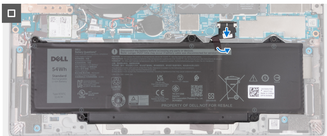
Рисунок 19. Отсоединение кабеля аккумулятора от системной платы
