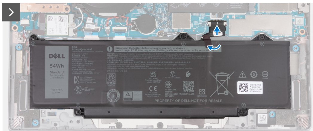
Рисунок 20. Подсоедините кабель аккумулятора к системной плате
