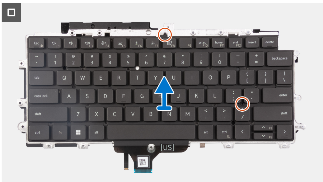
Рисунок 60. Снятие клавиатуры в сборе
