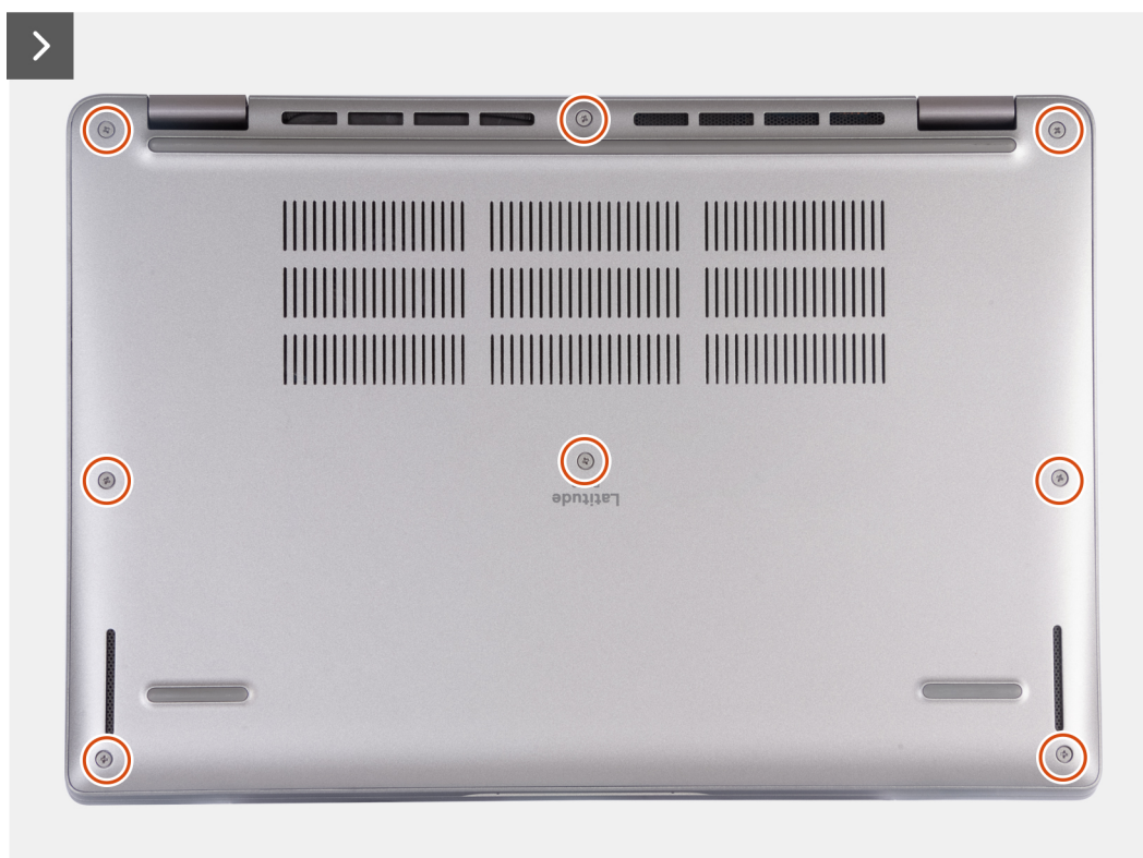
Рисунок 17. Ослабление восьми невыпадающих винтов, которыми нижняя крышка крепится к опорной панели в сборе
