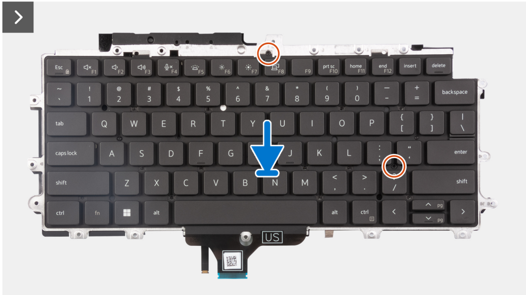
Рисунок 61. Установка клавиатуры в сборе
