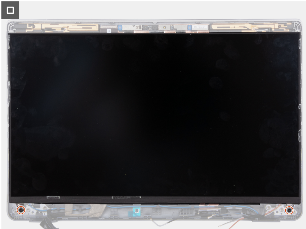
Рисунок 79. Вставка выступов на панели дисплея в пазы на крышке дисплея
