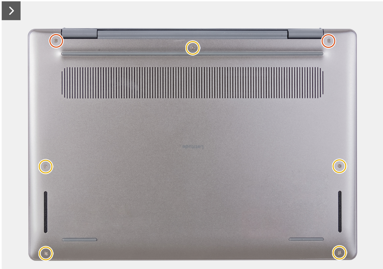
Рисунок 16. Снятие нижней крышки
