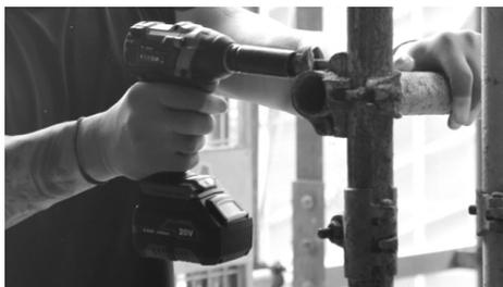
Крепко удерживая инструмент, поместите головку на болт или гайку. Включите инструмент и закрепите болт или гайку. Время затягивания может отличаться в зависимости от вида или размера болта, материала закрепляемой детали и т.д. Соотношение между моментом крепления и временем крепления показано на графиках ниже.
