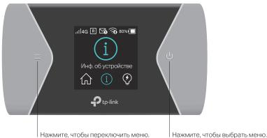
**70** all Качество сигнала Состояние подключения 4G/3G/2G Тип сети 80% Заряд аккумулятора 560 мь R Общий расход трафика Роуминг данных  $\square$ 50 M/C Скорость загрузки Сообщение
