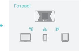
По умолчанию включён режим энергосбережения, при котором Wi-Fi автоматически отключается, если на протяжении 10 минут нет активных подключений. Для возобновления подключения нажмите на любую кнопку устройства.
