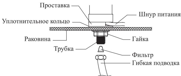
Если вы собираетесь пустить шнур питания под раковиной, то наденьте на трубку уплотнительное кольцо. Установите устройство в отверстие раковины, снизу на трубку установите проставку и проденьте шнур питания через углубление на проставке. Затем установите гайку и с ее помощью зафиксируйте проточный водонагреватель. Гайка должна быть зажата плотно, но не перетянута. Убедитесь, что внутри трубы установлен фильтр.
