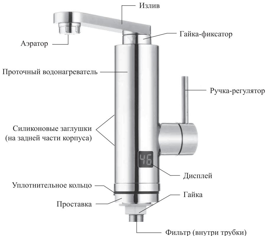
Принцип работы устройства прост: в корпусе водонагревателя установлен мощный нагреватель (ТЭН). Водопроводная вода, проходя через ТЭН, быстро нагревается до 65 °С.
