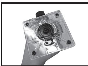
Приставьте фрезер с копирующей втулкой к шаблону. Ведите фрезер с выступающей копирующей втулкой по шаблону, прикладывая небольшое боковое усилие.
