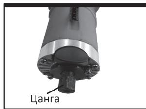
**ПРИМЕЧАНИЕ.** Не затягивайте зажимной винт без установленной фрезы.
