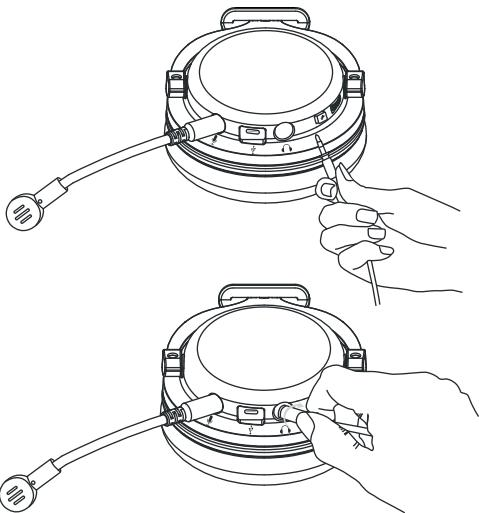
Подключите коннектор 3.5 мм к соответствующему разъему на наушниках, затем поверните коннектор вправо на 90°, чтобы зафиксировать его. После этого кабель нельзя будет отключить от наушников, потянув за него. Чтобы убрать фиксацию, поверните коннектор влево на 90°.
