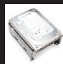
Вставьте HDD 3.5" в крепежный кронштейн
