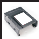
Расположение SSD в салазках HDD
