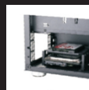
Установите крепежный кронштейн на место
