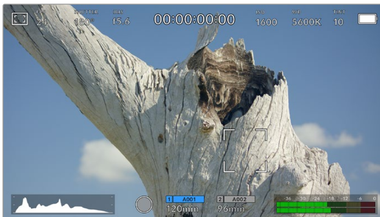
Сенсорный ЖК-дисплей камеры URSA Mini при фокусировке
