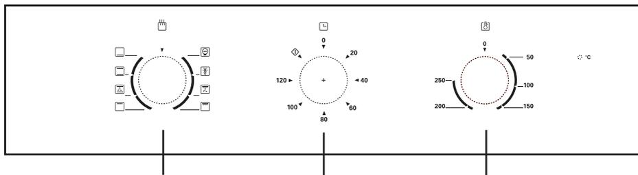
1. Переключатель функций 2. Таймер 3. Регулировка температуры
