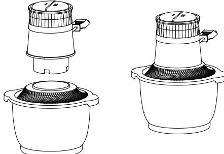
**Ескерту:** мотор бөлігінің дұрыс орнатылғанына көз жеткізіңіз. Пышақ жүздері мотор блогына дәл сәйкес келуі керек.
