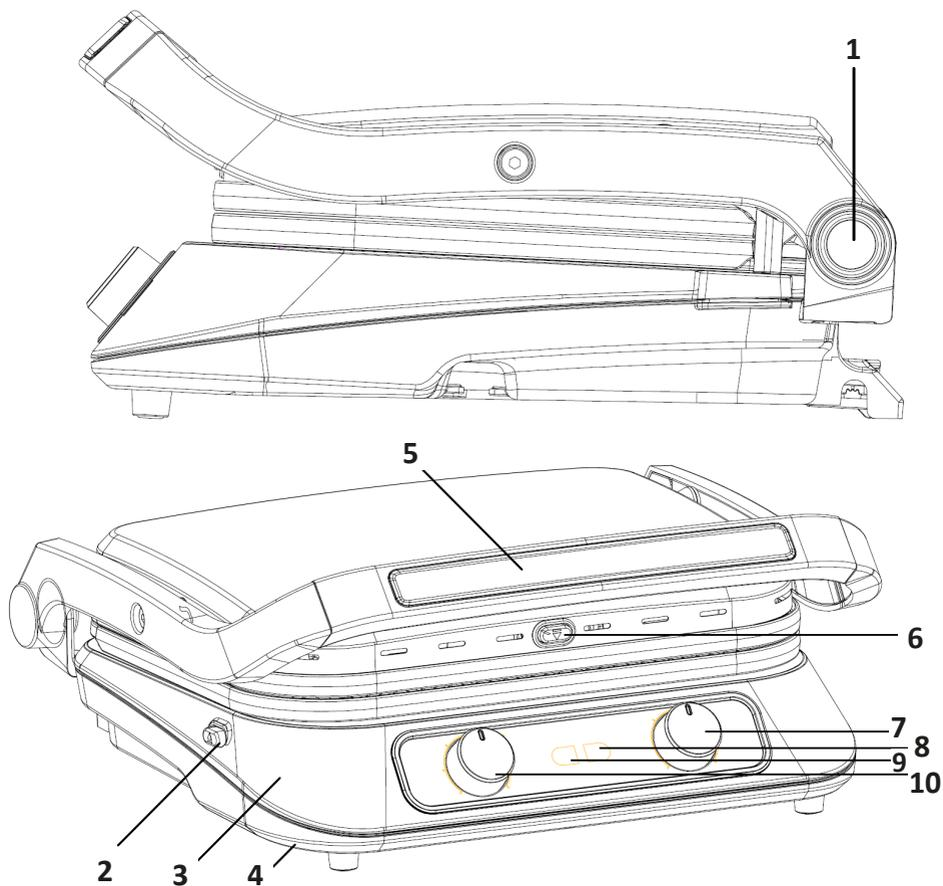
1. Кнопка раскладывания устройства на 180°.
