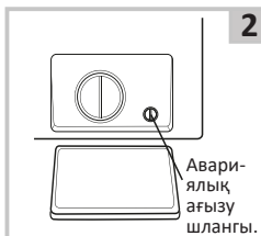
2 Төтенше су төгетін шлангтың бітегішін 90° бұраңыз және шлангты шығарыңыз. Бітегішті шешіңіз.
