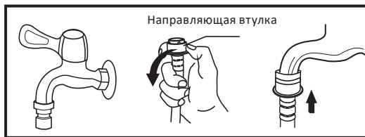
Специальный кран для стиральной машины
