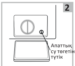
Апаттық су төгетін түтіктің тығынын 90° бұрап, шлангты тартып шығарыңыз. Штепсельді алыңыз.
