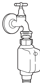
ПОДКЛЮЧЕНИЕ ЧЕРЕЗ ПРЕДОХРАНИТЕЛЬНЫЙ КЛАПАН
