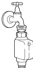
ПОДКЛЮЧЕНИЕ ЧЕРЕЗ ПРЕДОХРАНИТЕЛЬНЫЙ КЛАПАН
