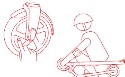
**!** НЕ трогайте мотор-колесо после катания, т.к. оно может быть горячим.
