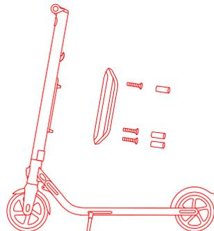
2. Установите рейку с помощью болтов М4 (10 мм) (3 шт.), прилагаемых к данному изделию. Пожалуйста, убедитесь, что она зафиксирована.
