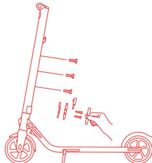
3. Установите внешнюю батарею на рейку и закрепите ее болтами М4 (20 мм) (2 шт.) и винт М3 (1 шт.), прилагаемыми к данному изделию. После установки заткните отверстия резиновой пробкой.
