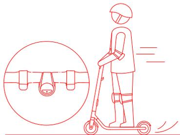
4. Сбавьте скорость, отпустив рычаг газа. Сожмите электронный тормоз и одновременно топните крыло ногой для внезапного торможения.
