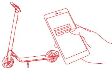
Нажмите «Транспортное средство» (Vehicle) → «Поиск скутера» (Scan for Vehicle), чтобы подключиться к своему KickScooter. При успешном подключении KickScooter издаст звуковой сигнал. Значок Bluetooth перестанет мигать и останется гореть.
