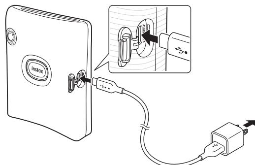
Подключите принтер с помощью прилагаемого кабеля USB Type-C к адаптеру USB AC (поставляется в комплекте со смартфоном), а затем подключите адаптер переменного тока USB к источнику питания в помещении.
