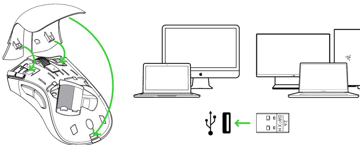
3. Установите переключатель в положение режима Razer™ HyperSpeed Wireless (2,4 ГГц). После подключения индикатор состояния будет некоторое время светиться зеленым.
