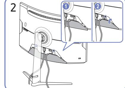
Расположите кабели, учитывая сгибаемость, и извлеките кабели из НИЖНЕЙ КРЫШКИ ЗАДНЕЙ ПАНЕЛИ.
