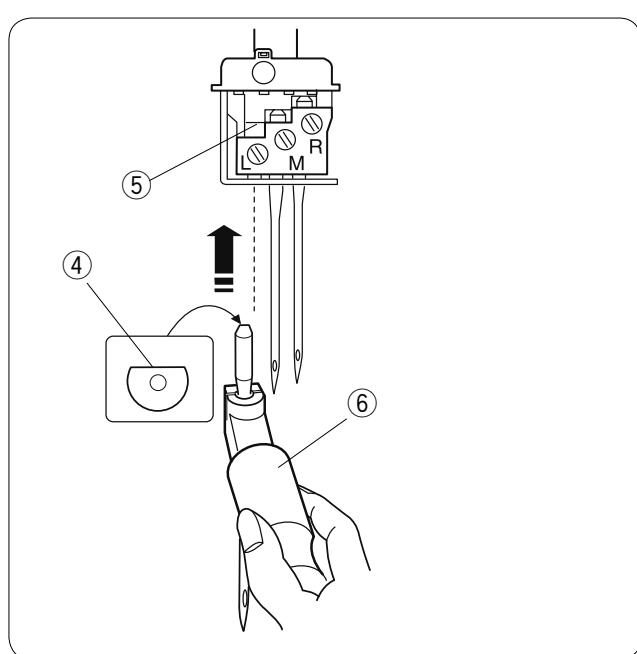
Вставьте новую иглу в отверстие иглодержателя плоской стороной назад, подтолкните иглу вверх к стопору. Затем затяните винт.
