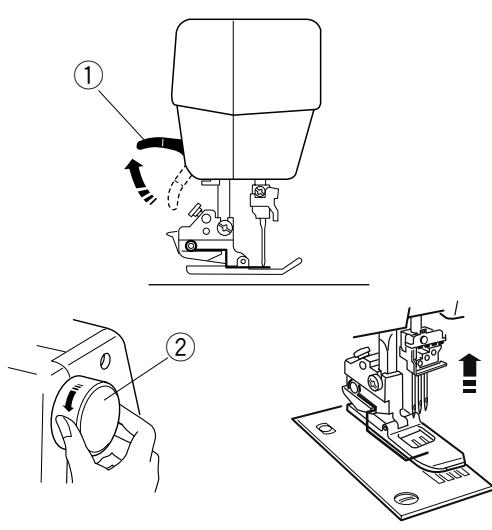
Поднимите рычаг прижимной лапки.
