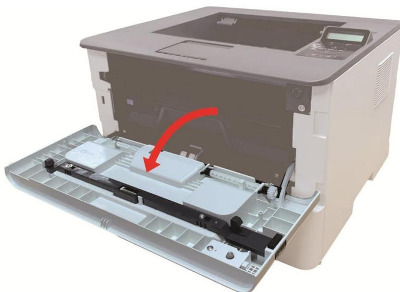
5. Вынимайте лазерные картриджи вдоль направляющего рельса. (уберите лазерные картриджи в лоток или пакет для предотвращения попадания на фотобарабан прямых солнечных лучей.)
