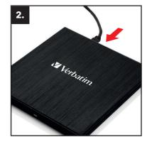
Подключите интерфейсный кабель USB к устройству.
