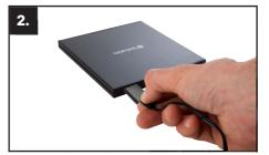
Подключите интерфейсный кабель USB к компактному внешнему пишущему приводу дисков CD/DVD.
