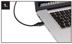
Подключите кабель USB к интерфейсному порту компьютера. Для большинства компьютеров подачи питания только через порт передачи данных будет достаточно.
