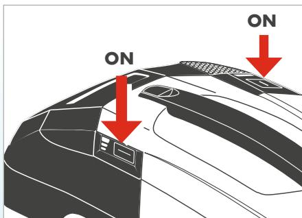
Schalten Sie das Gerät ein und wählen Sie die gewünschte Leistungsstufe.
