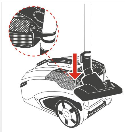
Benutzen Sie die Parkhilfe an der Rückseite des Gerätes, um das Saugrohr am Gerät zu befestigen.
