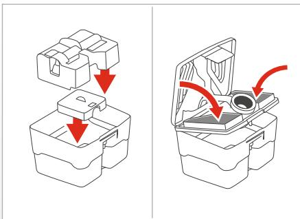
Wurde der Ansaugfilter entnommen, setzen Sie diesen in den Schmutzwasserbehälter ein.
