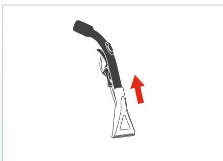
Bei Verwendung der Polster-Waschsaugdüse schließen Sie diese direkt an dem Handgriff des Saugschlauchs an.
