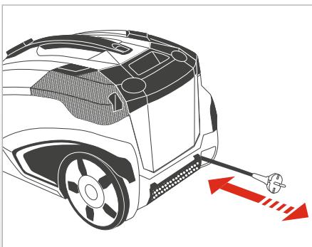
Ziehen Sie den Netzstecker aus der Steckdose. Ziehen Sie das Netzanchlusskabel mit leichtem Zug vom Gerät weg und lassen Sie es los. Das Kabel rollt sich dann automatisch auf.
