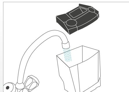
Gehäuse des Gerätes reinigen
