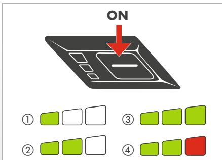
Schalten Sie das Gerät durch kurzzeitiges Drücken der Starttaste ein.
