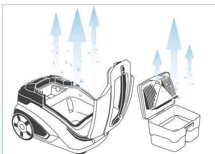
Reinigen und trocknen Sie den Aquafilter, die verwendeten Düsen sowie das Gehäuse des Gerätes nach jedem Gebrauch.
