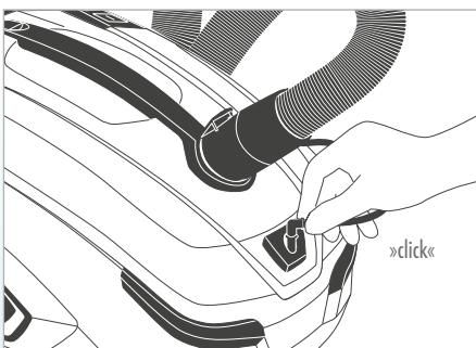
Schließen Sie die Sprühleitung über die Schnellkupplung am Gerät an.
