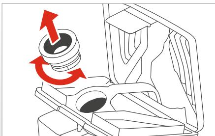
Der Ejector kann durch Drehen der Stutzendichtung für die Reinigung entnommen werden.
