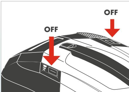
Wenn der Frischwassertank leer ist bzw. zum Beenden der Reinigung, schalten Sie die Pumpe durch Drücken der Pumpentaste aus. Schalten Sie das Gerät durch Drücken der Starttaste aus.
