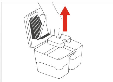
Sofern sich Schmutzwasser im Schmutzwasserbehälter des Aquafilters befindet, gießen Sie dieses über die Ausgieöffnung aus.
