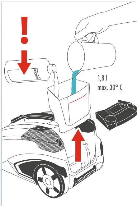
Entnehmen Sie den Frischwassertank aus dem Gerät. Befüllen Sie den leeren Frischwassertank mit maximal 1,8 Liter Frischwasser (handwarm, maximal 30 °C). Setzen Sie den Frischwassertank wieder in das Gerät. Zum Aus- und Einbau des Frischwassertanks siehe Kapitel „Reinigung“, Abschnitt „Frischwassertank reinigen“.
