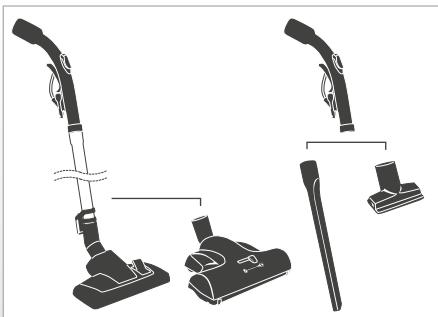
Schließen Sie das Teleskoprohr und/oder die für den gewünschten Anwendungsfall ausgewählte Düse an den Handgriff des Saug-schlauches an.
