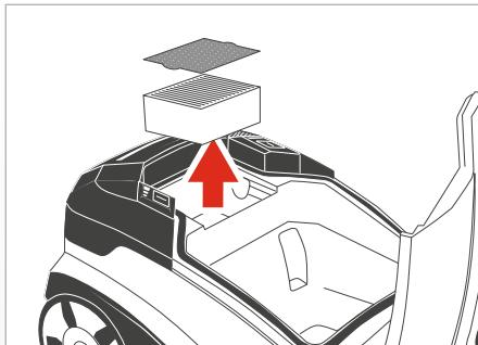
EPA-FILTER und EPA-Vorfilter reinigen
