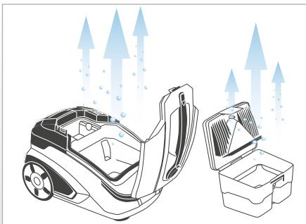
Reinigen und trocknen Sie den Aquafilter sowie das Gehäuse des Gerätes nach jedem Gebrauch.
