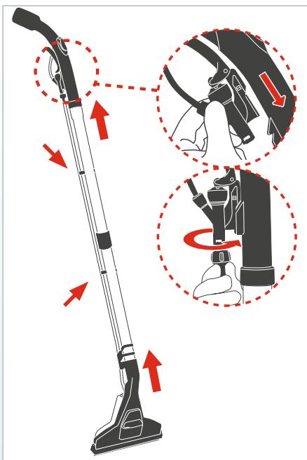
Schließen Sie das Teleskoprohr mit der passenden Seite an den Handgriff des Saugschlauches und die Waschsaugdüse an das Teleskoprohr an.
