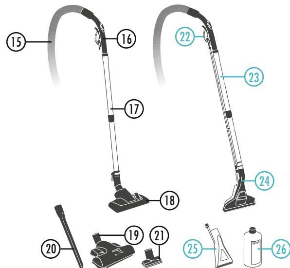
Синим цветом обозначены детали, которые используются только при влажной уборке и сборе жидкостей.
