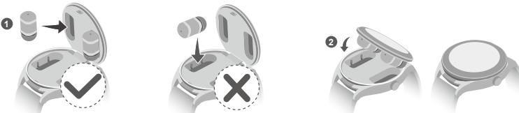
**1** Coloca los auriculares directamente en el interior de la tapa del reloj, con los tapones mirando hacia abajo.
