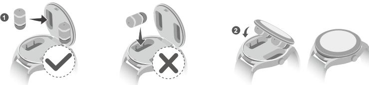
1 Tempelkan earphone secara langsung ke bagian dalam penutup jam tangan, dengan ear tip menghadap ke arah bawah.
