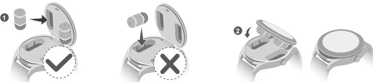
1 イヤーチップを下に向けた状態で、イヤホンをウォッチの蓋の内側に直接取り付けます。
