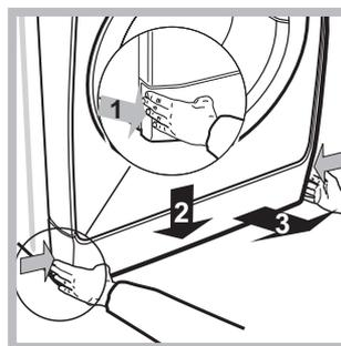
1. Mashina oldidagi qopqoq panelni dastlab markaziga bosib, so'ngra chiqib kelguncha ikki tarafidan pastga bosib bilan chiqarib oling (*rasmlarga qarang*).
