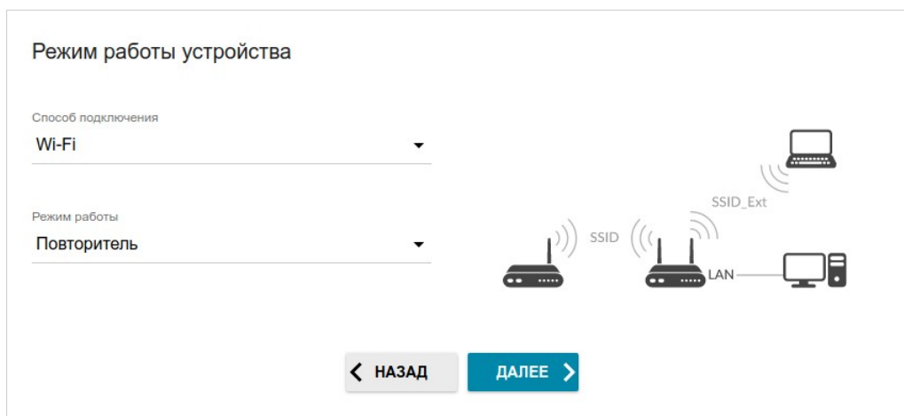
Рисунок 36. Выбор режима работы устройства. Режим Повторитель .
