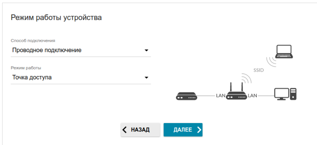
Рисунок 35. Выбор режима работы устройства. Режим Точка доступа .
