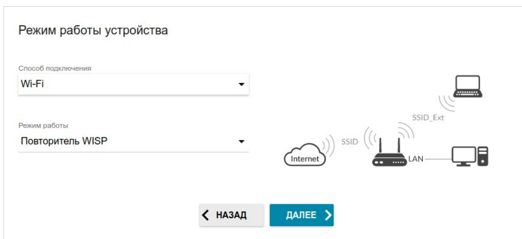
Рисунок 34. Выбор режима работы устройства. Режим Повторитель WISP .
