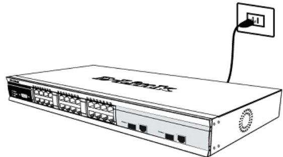
Рисунок 4. Подключение коммутатора к розетке
